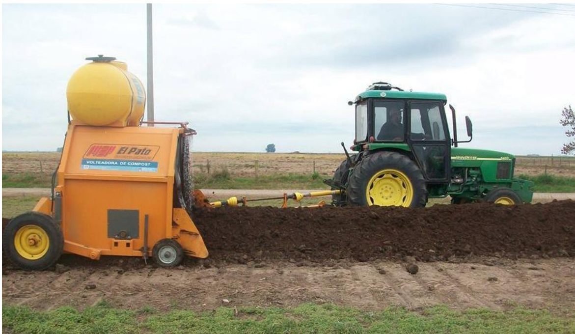
Figura 2. Maquina volteadora de compost INTA-Metalmecánica “El Pato”
